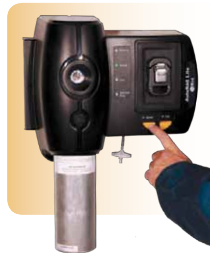
Funktionstest des ToxiRAE 3 mit der Funktionstest- und Kalibrierstation des AutoRAE Lite
