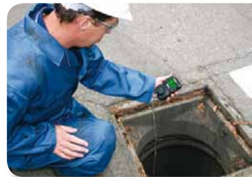
QRAE II wird mit integrierter Pumpe für den Einsatz unter beengten Verhältnissen verwendet
